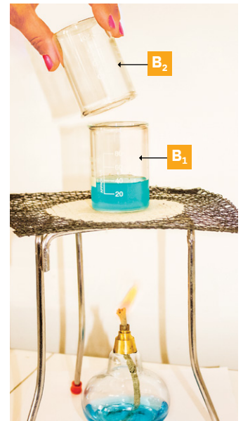
Aufbau zum Erwärmen des Gemenges aus Wasser und Blausteine
