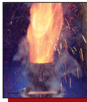
Fig. 9. Reacția exotermă dintre Al și \text{Fe}_2\text{O}_3 , cunoscută sub denumirea de „reacție termită”, decurge violent după momentul declanșării.
