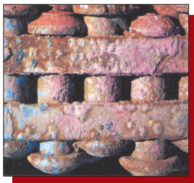
Fig. 2. Ruginirea fierului este un proces redox. Cunoașterea reacțiilor care se produc este importantă pentru identificarea metodelor de combatere a coroziunii fierului.
