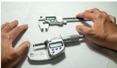
Fig. 2 - Instrumente de măsură digitale: șubler, micrometru
