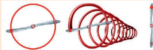
Traiectoria punctului roșu de pe elicea unui avion care zboară, văzută din 3 sisteme de referință: avionul, Pământul și elicea.
