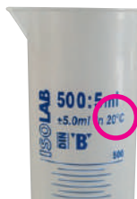
Fig. 1 - Cilindru gradat etalonat la 20 °C
