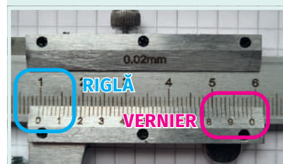
Fig. 6 - Care este indicația șublerului din această imagine?
