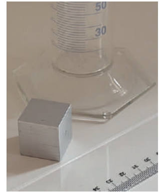
Fig. 4 - Determinarea indirectă și directă a volumului cubului
