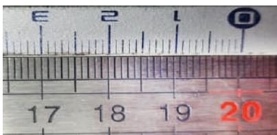
Fig. 3 - Calibrarea unei rigle utilizând o riglă reper
