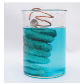
Figura 6. Sârma de cupru acoperită cu un strat argintiu și o soluție albastră
