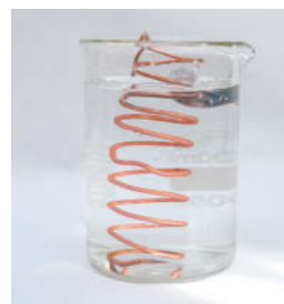
Figura 5. Pahar Berzelius, sârma de cupru și o soluție incoloră de azotat de argint
