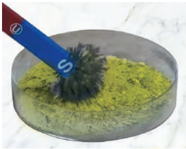
Figura 4. Separarea piliturii de fier din amestec cu ajutorul magnetului
