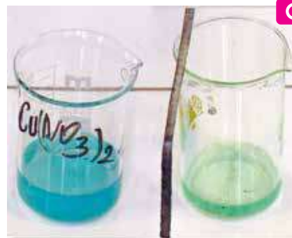
a) Înainte de a introduce sârma de aluminiu b) După ce reacția a avut loc
